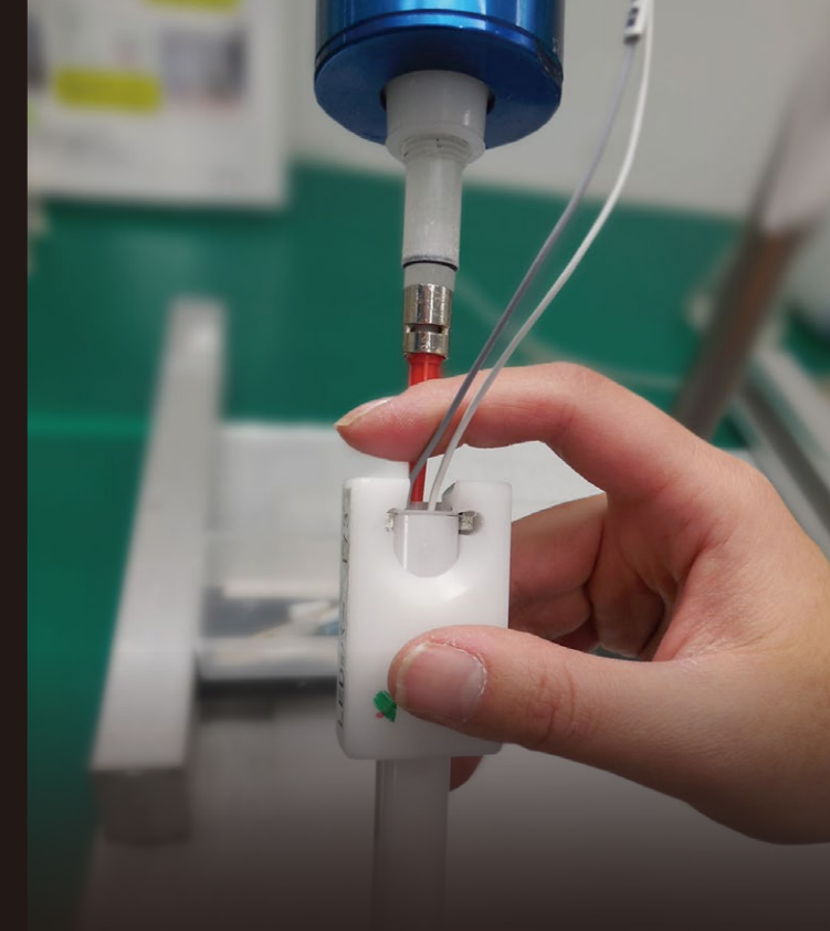
端末部の樹脂注入 (24V製品)
