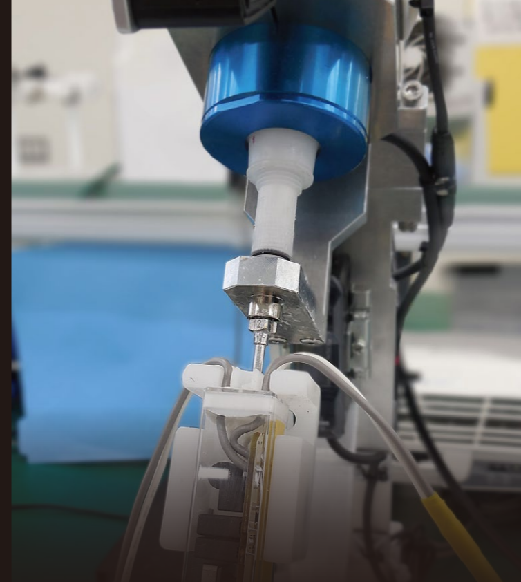
電源ユニットの樹脂注入 (100/200V製品)
