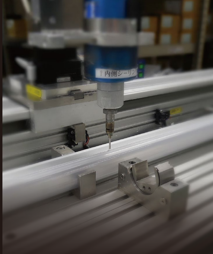
トップカバーの樹脂塗布 (100/200V製品)
