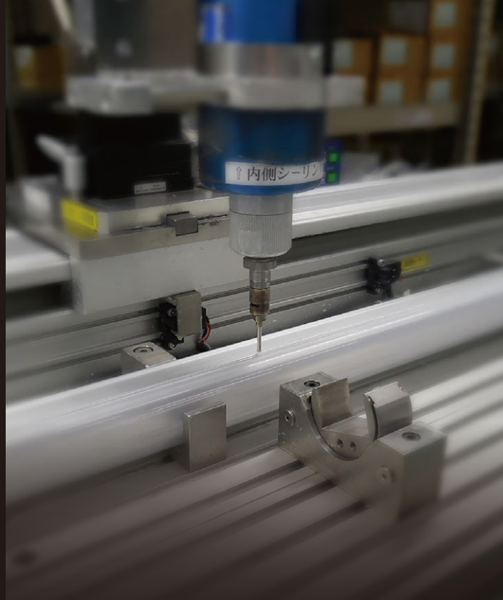
トップカバーの樹脂塗布 (100/200V製品)
