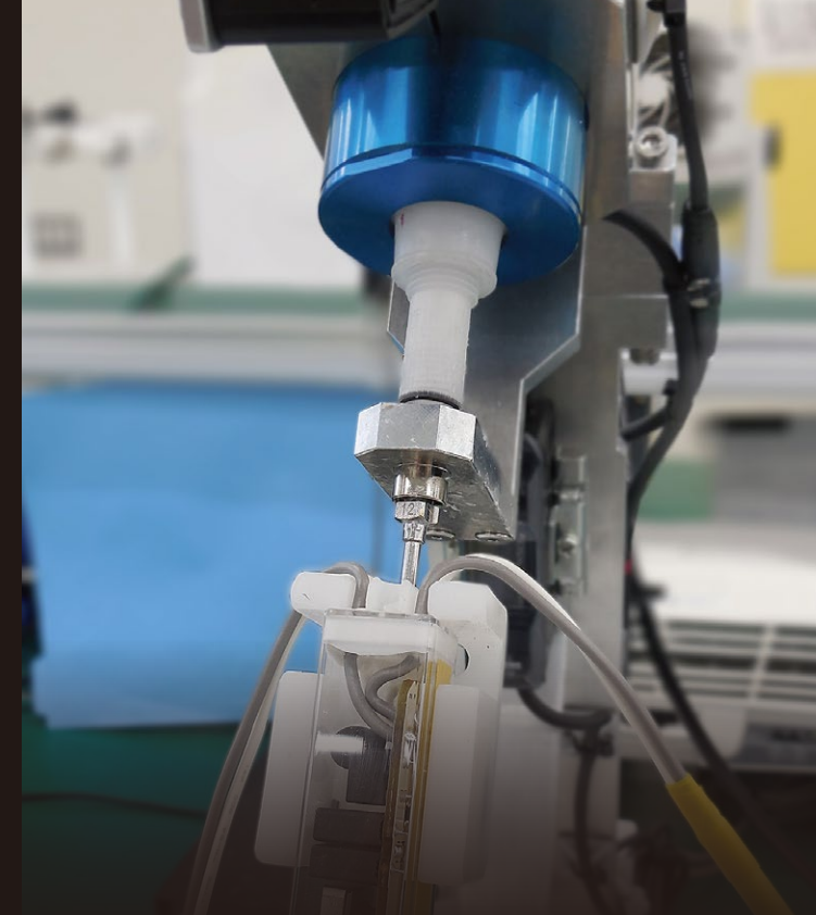
電源ユニットの樹脂注入 (100/200V製品)
