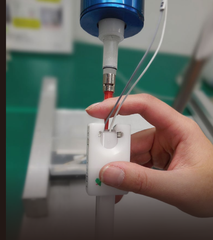
端末部の樹脂注入 (24V製品)
